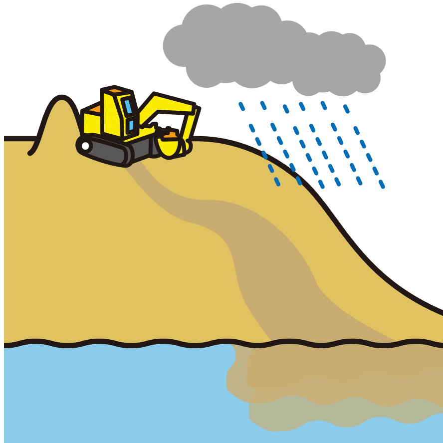
開発と大雨による土砂流出
